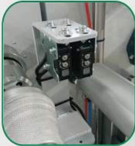
Sistema di controllo della centratura mediante fotocellule accoppiate.
