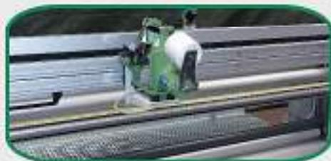
Predisposizione per cucitrice montata su guida scorrevole per facilitare l'operazione di giunzione pezza.
